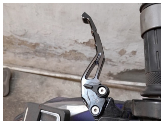
Gambar 5. Modifikasi rem pada setang kiri
