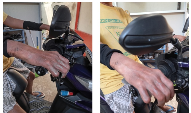
Gambar 6. Cara pasien memegang setang motor dan memposisikan tangan kanan pada gas dan rem yang telah dimodifikasi
