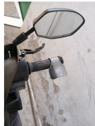
Gambar 4. Modifikasi gas pada setang kanan
